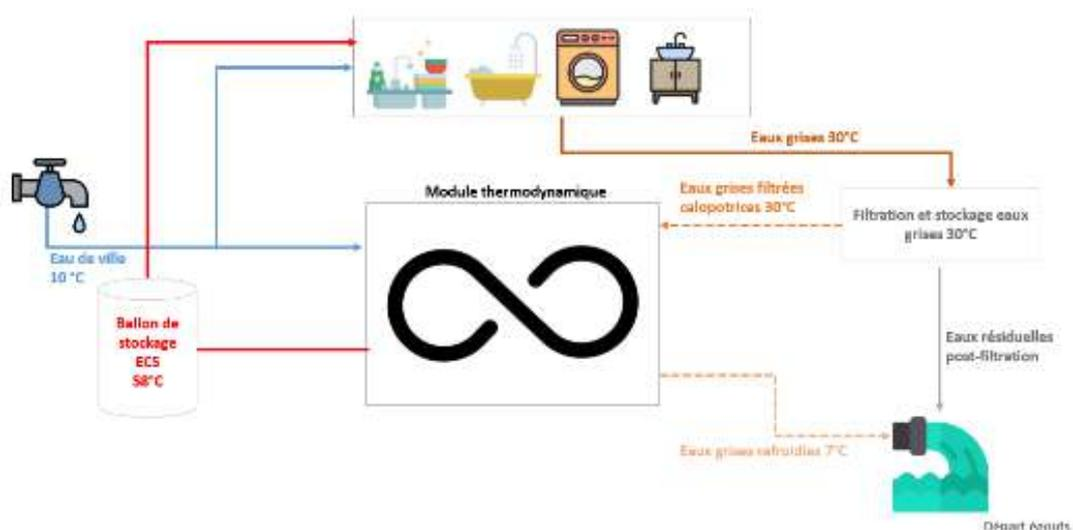
Figure 14 : Schéma de principe PAC récupération énergie
