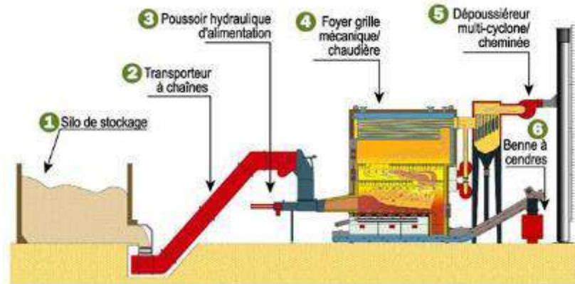
Figure 12 : Schéma de principe bois énergie
