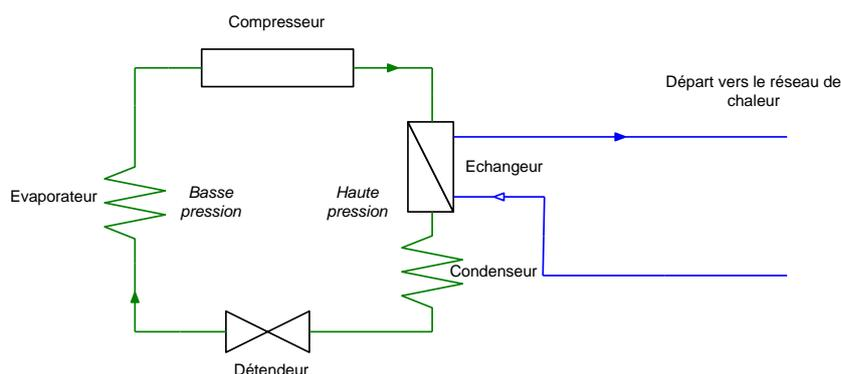
*Figure 15 : Schéma de principe récupération sur process*
