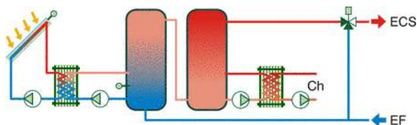
Figure 6 : Schéma d'un dispositif du solaire thermique
